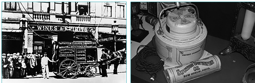
[그림 1] (왼쪽)세실 부스가 만든 최초의 진공청소기, (오른쪽)세계 첫 상용 진공청소기 '모델 O', 출처: ssplprints.com (2024.11.2.)
